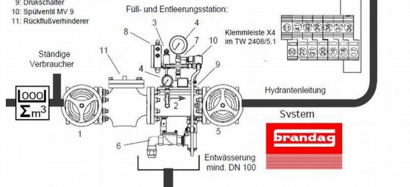
**Die Füll- und Entleerungsstation ist in einem frostsicheren, gut belüftbaren Raum zu installieren, muss gut zugänglich sein und ist vor unbefugtem Eingriff zu schützen.**
